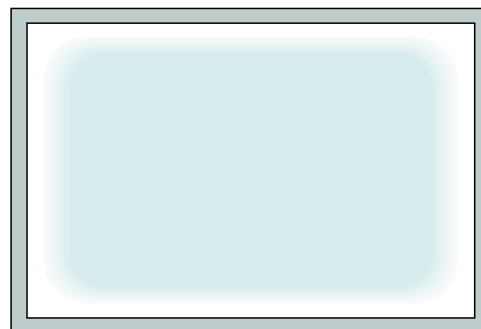
Condens aan de buitenzijde van de woning in het centrale gedeelte van het glas
