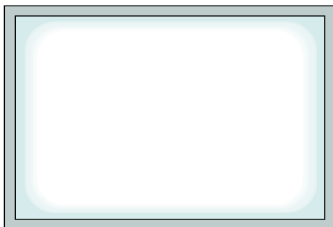
Condens aan de binnenzijde van de woning komt voor aan de rand van het glas
